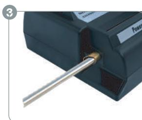
De injector blijft nu in deze positie staan en kan worden gereinigd met de borstels of een vochtige doekje.
